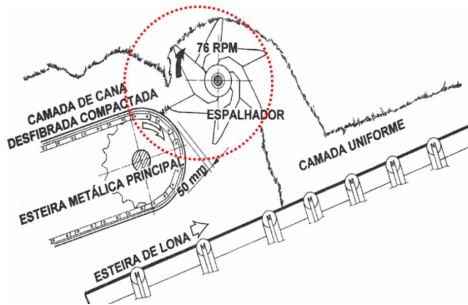
Figura 9.6.1 – Espalhador
