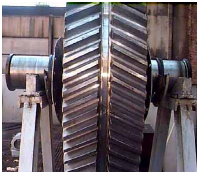
Figura 14.5.1 – Engrenagem Bi-helicoidal no cavalete para reparo
