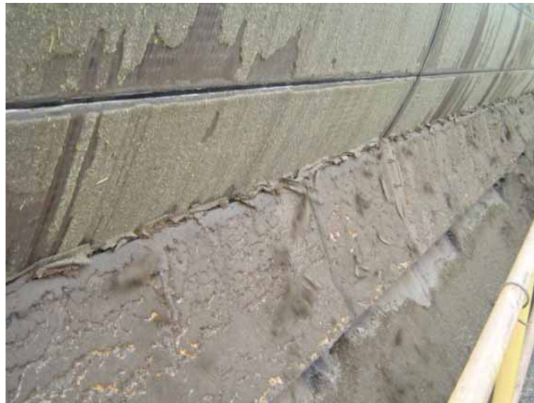
Figura 15.4.3 – Detalhe da retirada da Torta formada no Filtro Rotativo.
