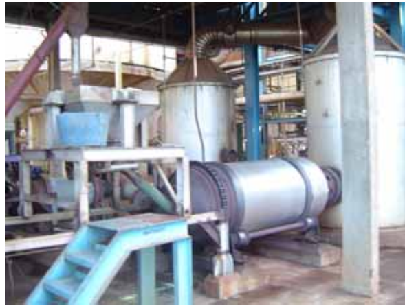
Figura 7.3.1 - Forno Rotativo para Queima de Enxofre
