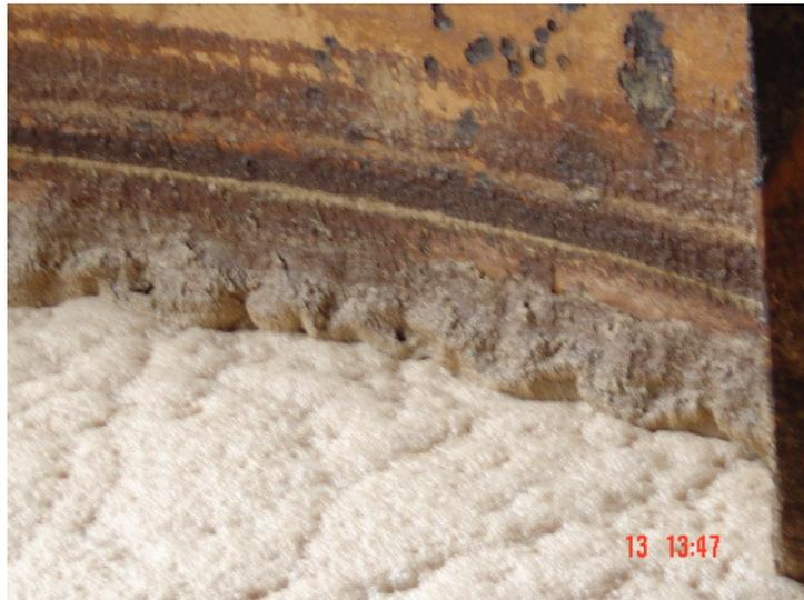
**Figura 4.3.1 (a) - Sistema Contínuo: maior parte dos processos instalados não permite assepsia das dornas**
