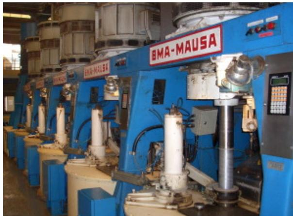
Centrifugas para separação do açúcar.
