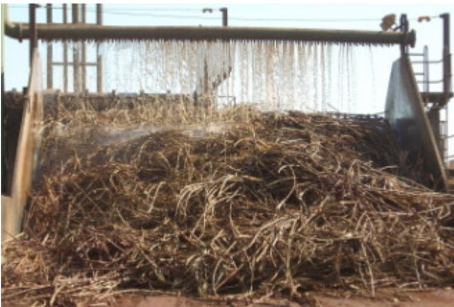
cana-de-açúcar para retirada de impurezas.
